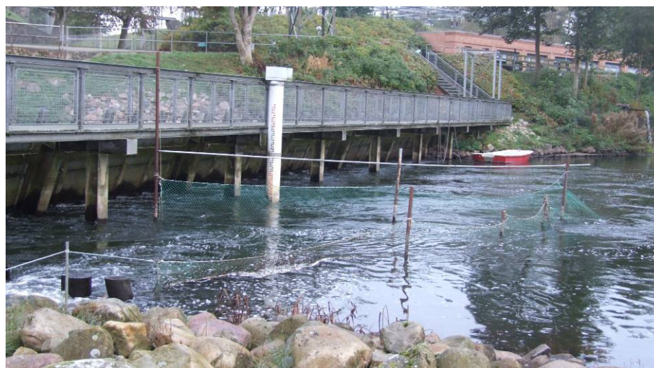
Figur 4. Ledegarnet blev sat i et V mellem ledegitteret og fisketrappens udmunding (nederst til venstre). Under broen på ledegitteret var der en ca. 1 m bred åbning som fiskene kunne komme igennem.
